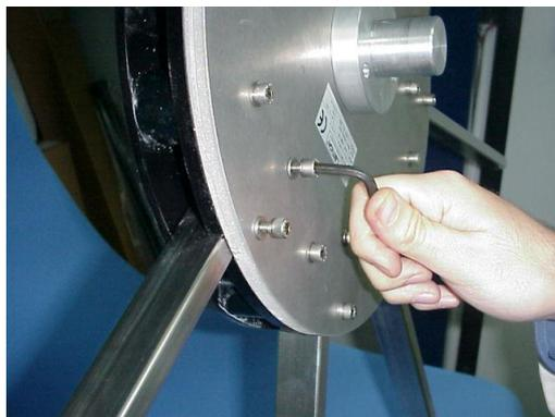
Figura 12. Apretar los tornillos mediante una llave Allen.
