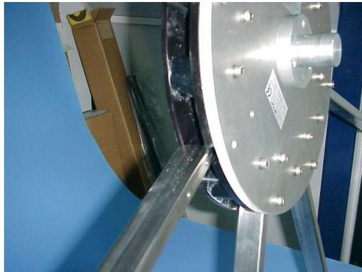
Figura 10. Inserción del brazo en la base circular.
