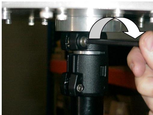
Figura 14. Fijación de la plataforma al soporte.
